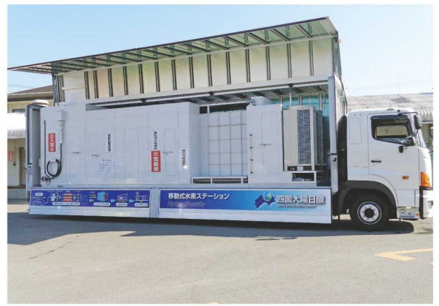
徳島県移動式水素ステーション
